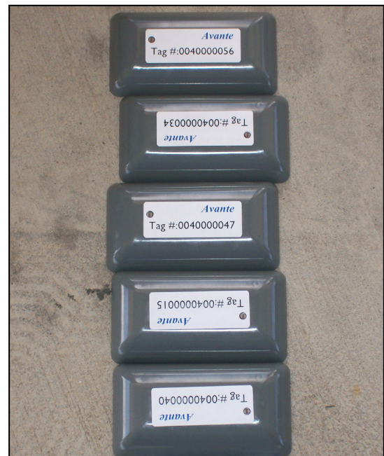
Figure 2-1. AVANTE's RFID Tags
