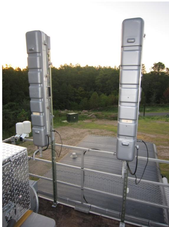
**Figure 3-2. Denuder/filter pack samplers.**
