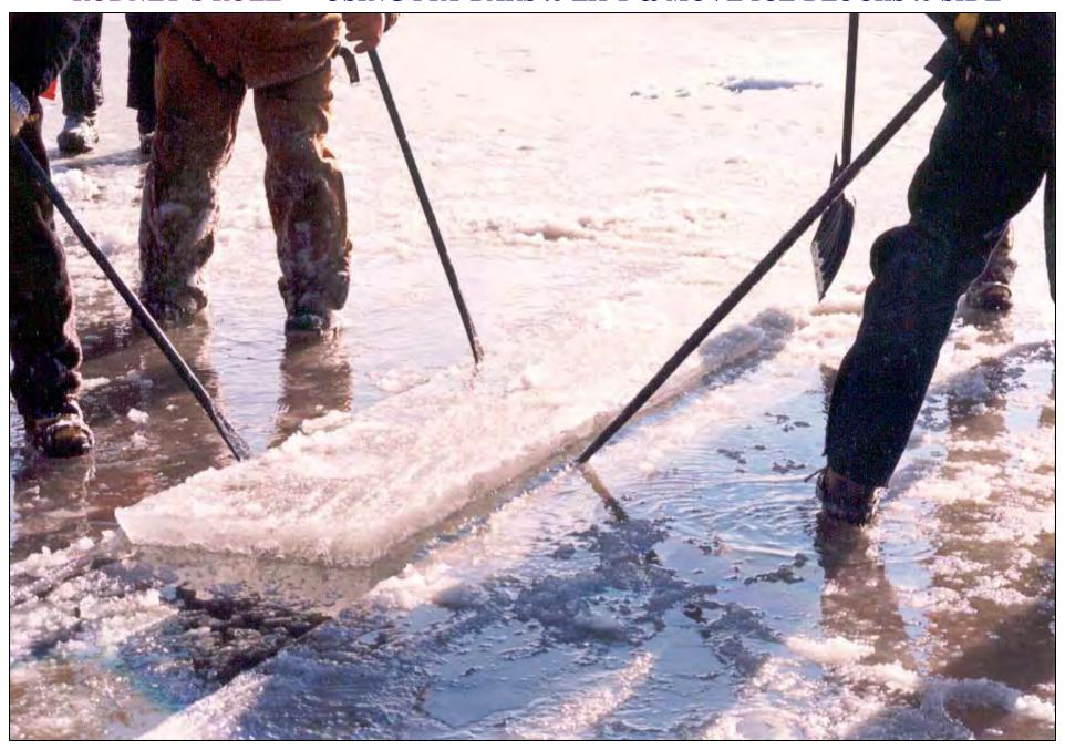
"RODNEY'S ROLL" - USING PRY BARS to LIFT & MOVE ICE BLOCKS to SIDE
